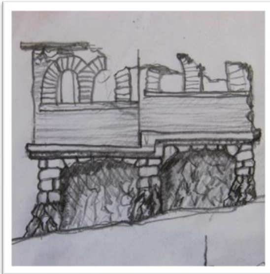
Am Hang sind Stützmauern nötig, um Fundamente für die Häuser zu schaffen.
